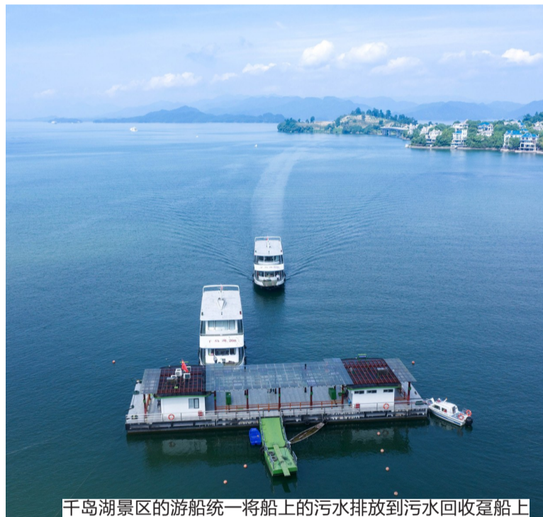
千岛湖景区的游船统一将船上的污水排放到污水回收趸船上
